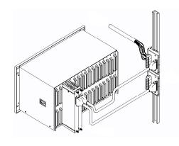
Блоки внешнего подключения, к которым подсоединяются полевые кабели, установлены на DIN-рейке и подсоединены к модулям ввода/вывода 3500 кабелями.
