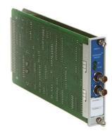
ния для двух датчиков фазы. Когда используется два или один датчик фазы, устанавливается только один модуль 3500/25. Сигналы фазы от модуля (модулей) 3500/25 Keyphasor через объединительную плату поступают в соответствующие мониторы для использования в измерениях скорости, фазы, настройки следящего фильтра и др.
